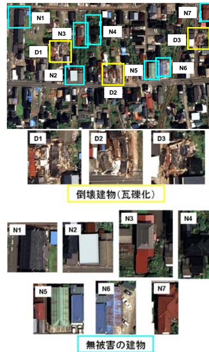
図3 倒壊建物と無被害建物の教師選定箇所
