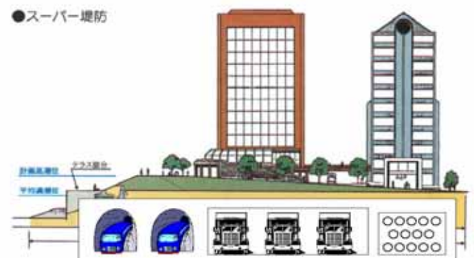
図6 PFIによるスーパー堤防の建設
