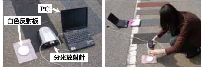
図 1 分光放射計機器と観測状況
