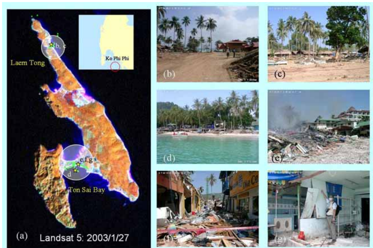
図6 ピピ島周辺の Landsat 衛星画像(2003/1/27)と被災状況。(a) Ko Phi Phi Don の調査地点と写真撮影位置、(b) & (c) Laem Tong 地区の様子。木造建物は壊れている、(d) 南から見た Ton Sai Bay、(e) 瓦礫の野焼きの様子、(f)津波による瓦礫で埋まる Ton Sai 地区の繁華街、(g) 商店の壁に残る津波による湛水を示す水位跡。
