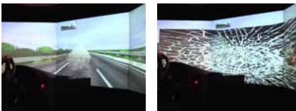
図6 ドライビングシミュレータによる高速道路走行時の早期警報模擬実験の様子
