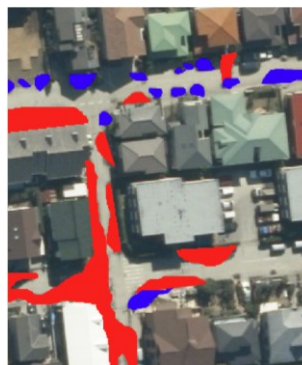
図2 液状化範囲を噴砂と集積砂に分けた例
