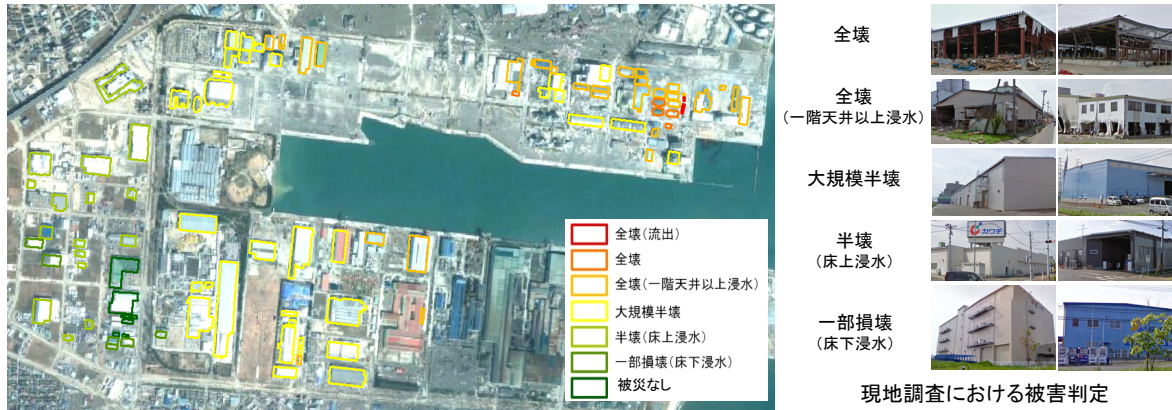
図9 精度検証に用いた対象建物と被害区分（計101棟）と現地調査における被害判定例 28)
