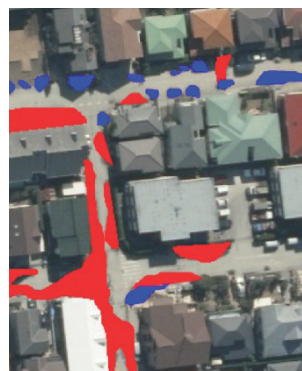
図3 液状化範囲を噴砂と集積砂に分けた例
