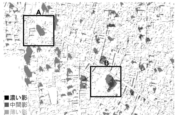
図-7 抽出された日影部分の3段階濃さ分類結果
