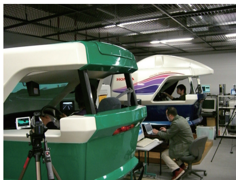
図1 2台のドライビングシミュレータを連動させた地震時走行模擬実験の様子
