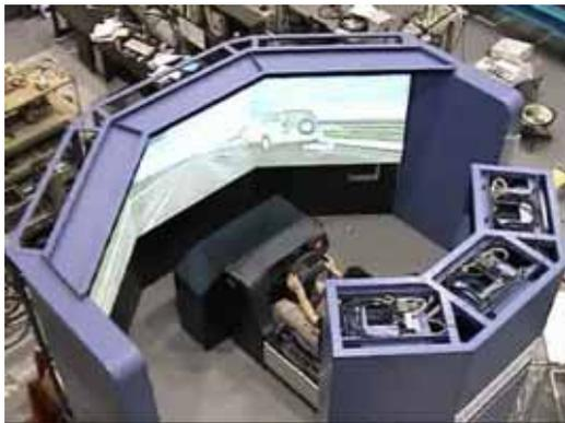
図-3 本研究で使用したドライビングシミュレータ
