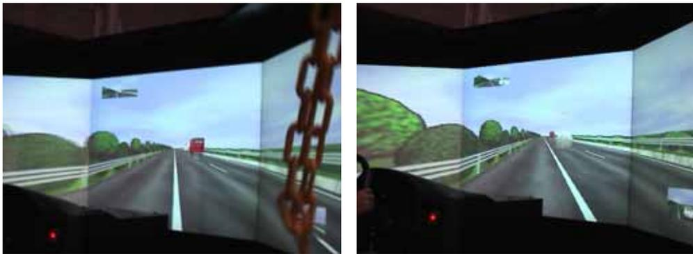
図-13 地震動早期警報を行ったときの走行実験の様子（路肩に停車し障害物を回避）
