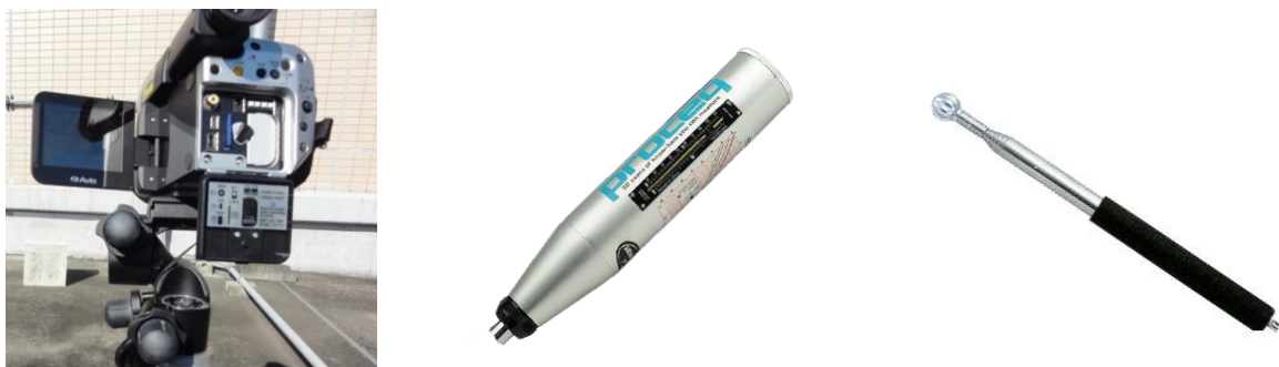
図1 本研究で使用した観測用機材. 左より熱赤外カメラ(日本アビオニクス InfReCR300SR-SS)、シュミットハンマー(富士物産 N形)、回転式打診棒(土牛産業 01738)
