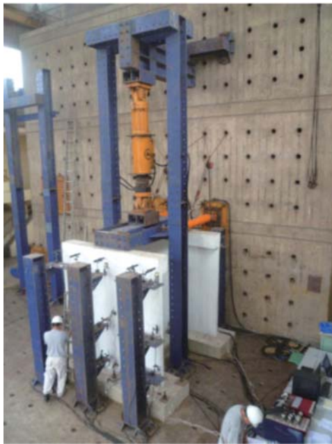
図 12 CISMID に導入した油圧式加力システム
