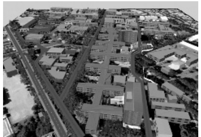
図-9 3次元建物モデルに航空写真と建物側面写真を貼り合わせて構築した千葉大学キャンパス
