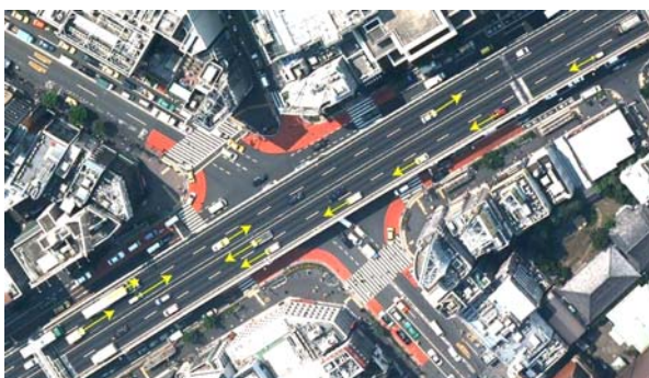
図-9 連続撮影したデジタル航空画像による車両速度抽出 30)
