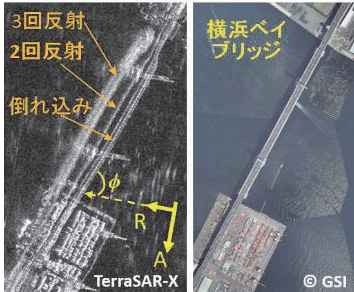
図1 横浜ベイブリッジ 高解像度衛星 SAR 画像 (左) と国土地理院の航空写真 (右)
