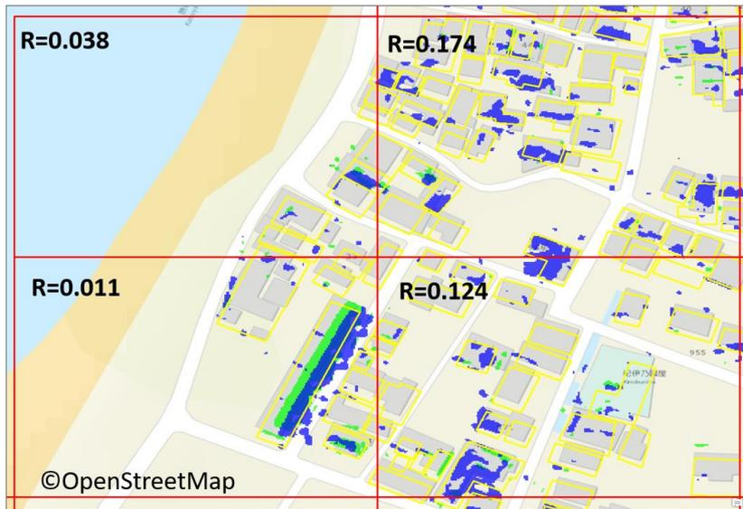
図4. 図2に示す衛星画像から抽出された青屋根を用いて算出した100mメッシュの屋根損傷率
