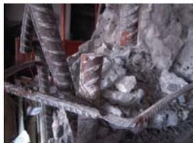
主筋破断部(拡大)
