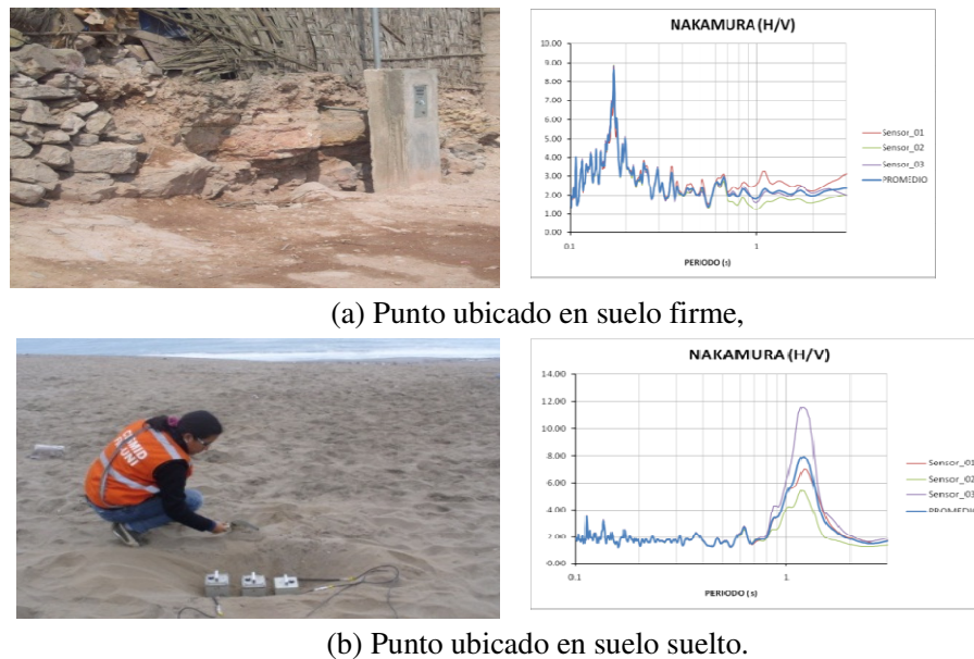
Figura 6: Puntos de microtrepidaciones medidos en Villa El Salvador. Se observa una clara relación de la geología con los valores obtenidos.
