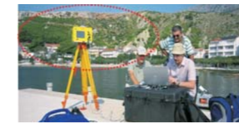
アドリア海沿岸の急斜面に分布する崩落危険性の高い岩盤ブロックの3Dレーザースキャナーによる位置計測状況 (スプリット近郊のDuceにおける計測事例)
