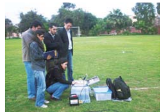
本プロジェクトで供与された機器を用いたリマ市内での常時微動の観測の様子。これにより地震時における地盤の揺れやすさが評価できる。
