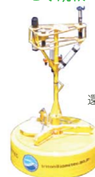
日本開発トライトフイ (TRITON, TRIangle Trans-Ocean buoy Network) のインドネシア技術者による運用
