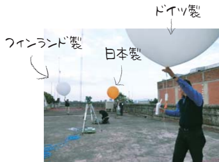
メキシコ気象局とのレーウィンソンデ (RawinSonde; 高層気象観測機器) 同時観測
