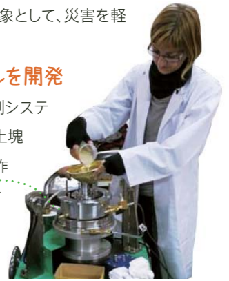
「地すべり再現試験機」を用いた研修の様子。日本で開発されたユニークな試験機を用いてクロアチアの地すべりの移動状況の解析技術が伝えられる。
