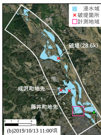
図 7 空撮画像の浸水域
