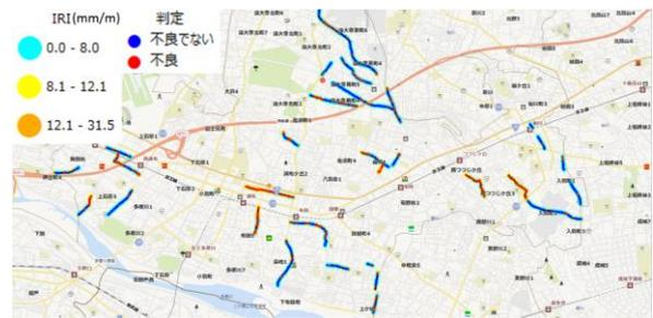
図-5 計測した IRI と提案モデルの判定結果の例
