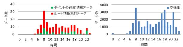
図-3 地点 1 で集計したデータ数と実際の交通量の比較
