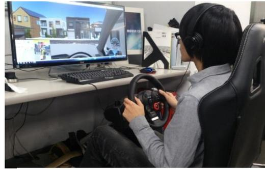
図5 簡易ドライビングシミュレータ
