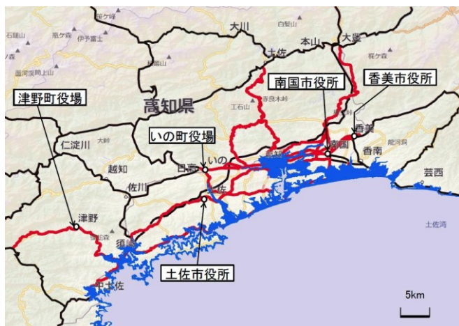
図-6 高知県の緊急輸送道路ネットワーク(黒色および赤色)のうち移動効率の高い道路(赤色)と南海トラフ巨大地震の浸水域(青色)の比較
