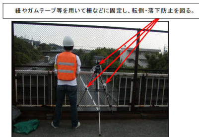
図-7.3.7 VTRカメラによる撮影状況とカメラの固定状況の例
